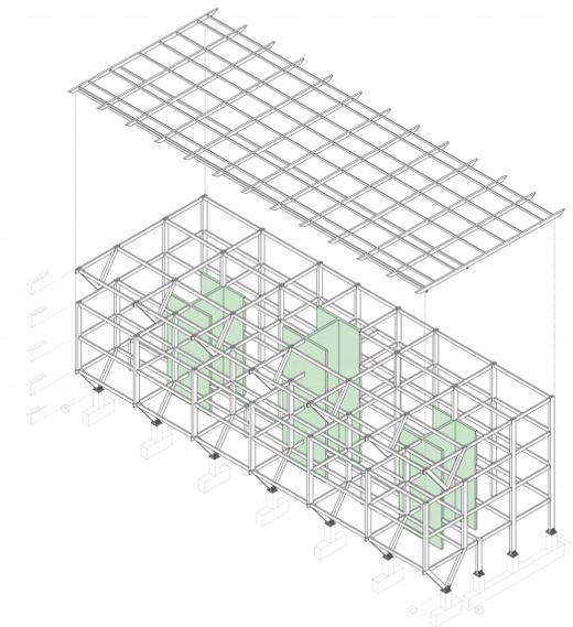
ESTRUCTURA PORTANTE / PILAR-MURO-VIGA
